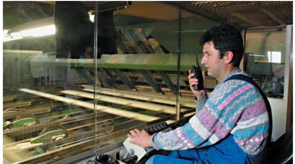
**Abb. 6:** Sägewerk. Bohlen werden nach DIN 4074 sortiert
